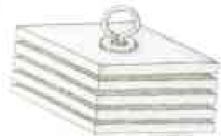
Gambar 5.23. A Hester-dendies : Pengambilan sampel substrat buatan
