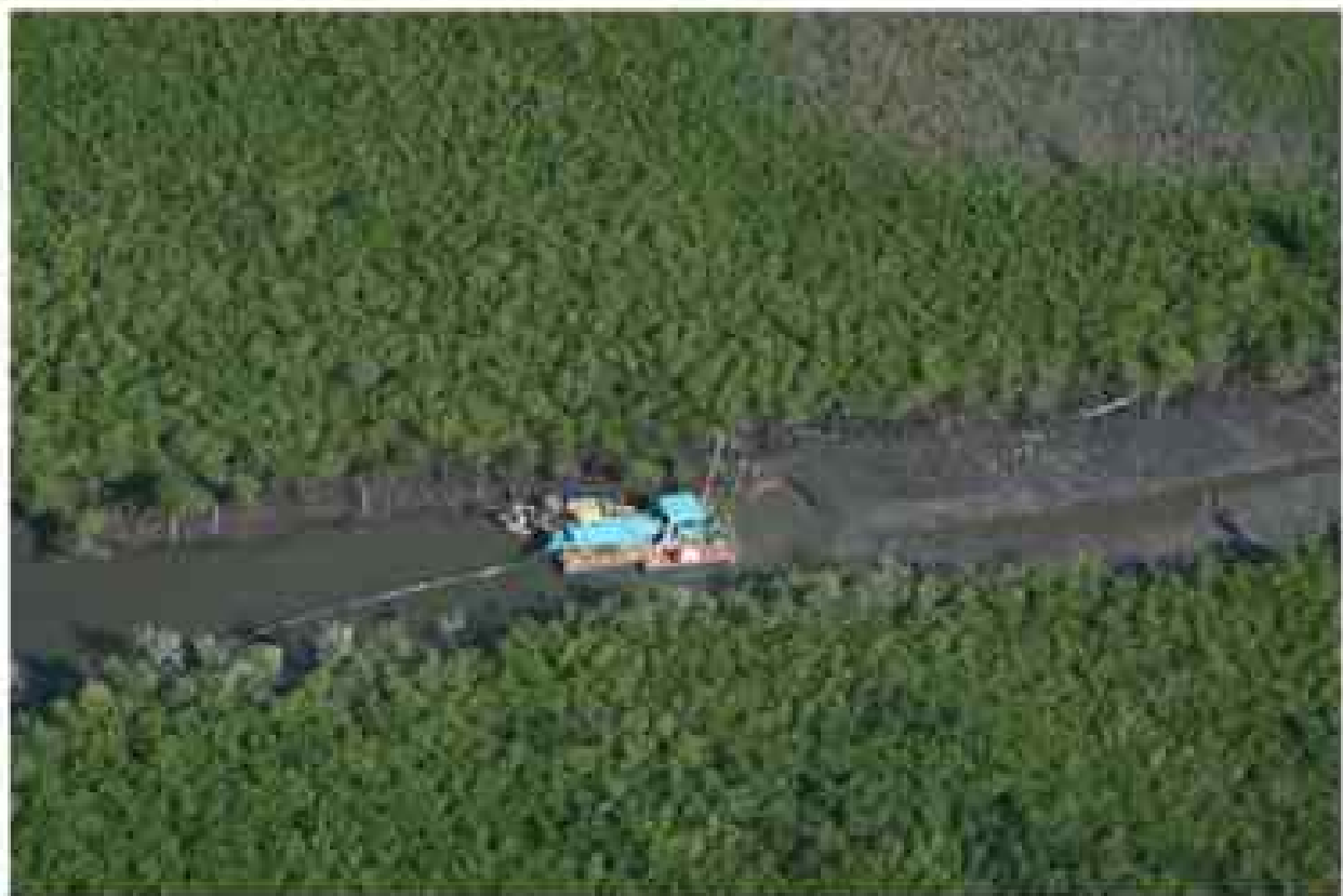
Gambar 8. 4. Alat pengukur mengapung yang membentuk saluran pasang surut untuk melancarkan pasang surut yang menyebabkan matinya mangrove di Tampa Bay, Florida, USA, (Lewis)
