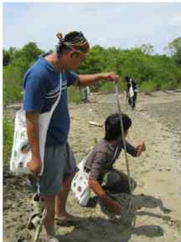
Gambar 5.14. Menggunakan waterpass untuk mengukur ketinggian substrat menuju tepi darat mangrove yang jarang tergenang air pasang
